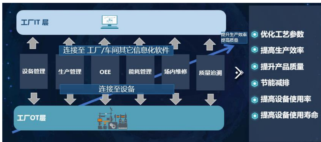
图 5 智能生产系统架构
