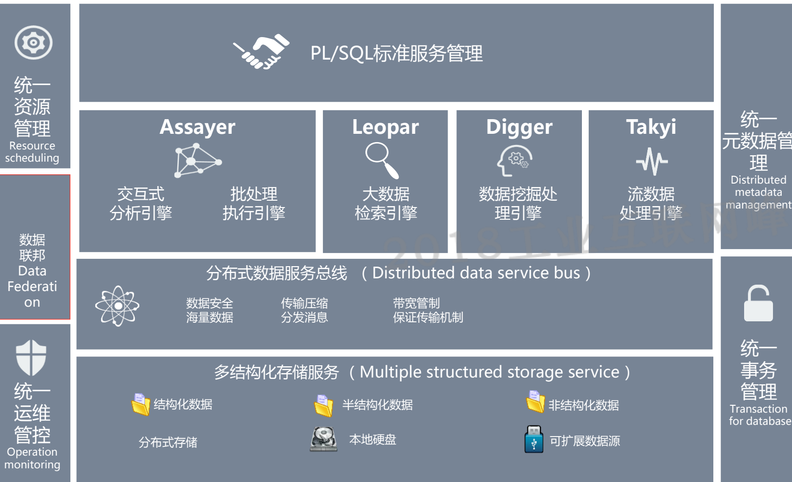
图例：BONC分析型云数据库产品结构
