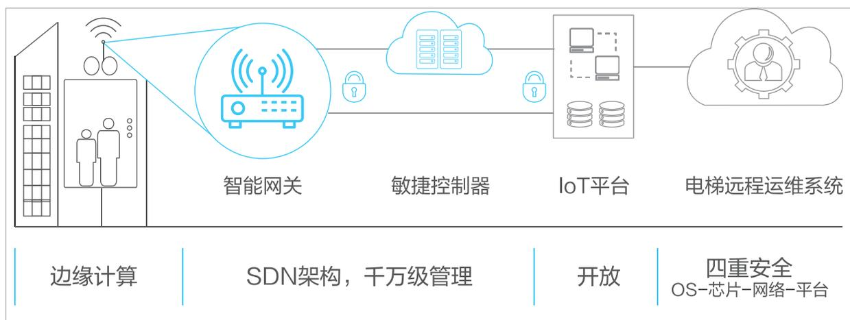
图16 梯联网方案总体架构图
