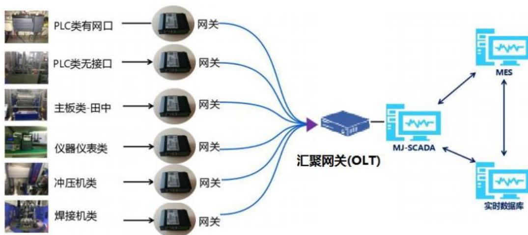
图 2 离散制造业工业 PON 组网架构图
