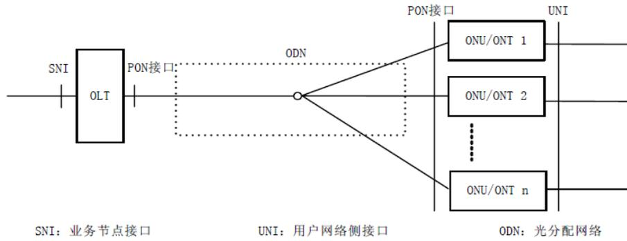
图 10 工业 PON 系统参考架构
