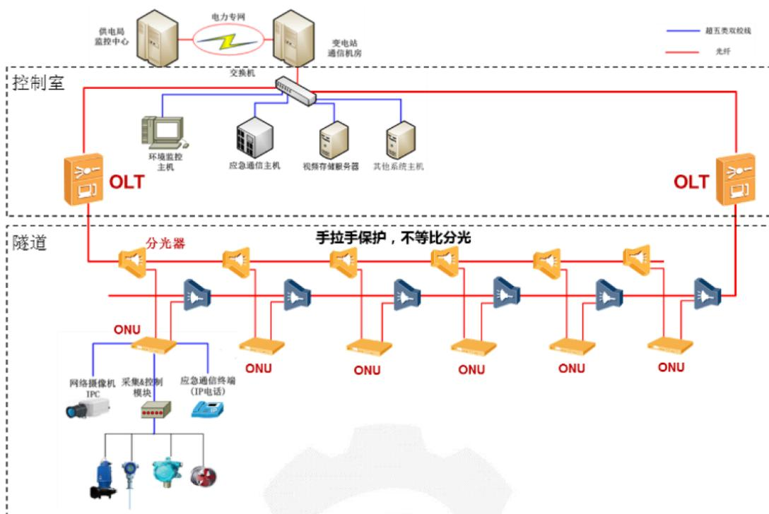
图 6 综合管廊应用组网架构图
