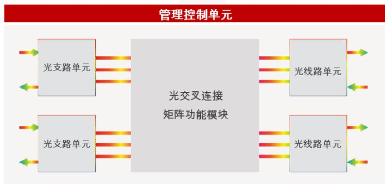
图 15 OXC 结构示意图
