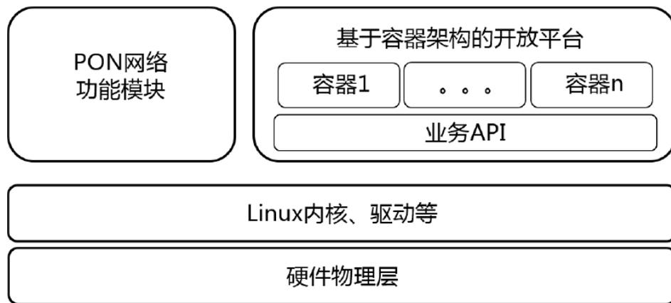
图 12 ONU 侧开放平台的架构
