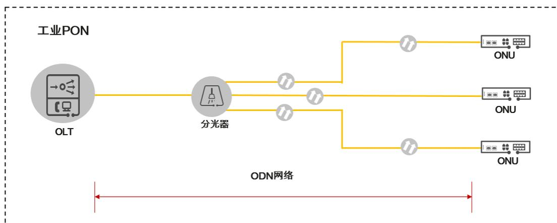
图 16 ODN 网络结构图
