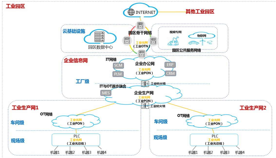
图 1 工业光网的体系架构图
