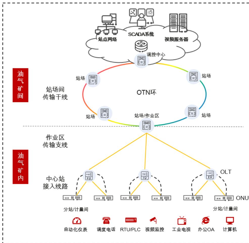
图7 工业光网在油气行业的应用组网图
