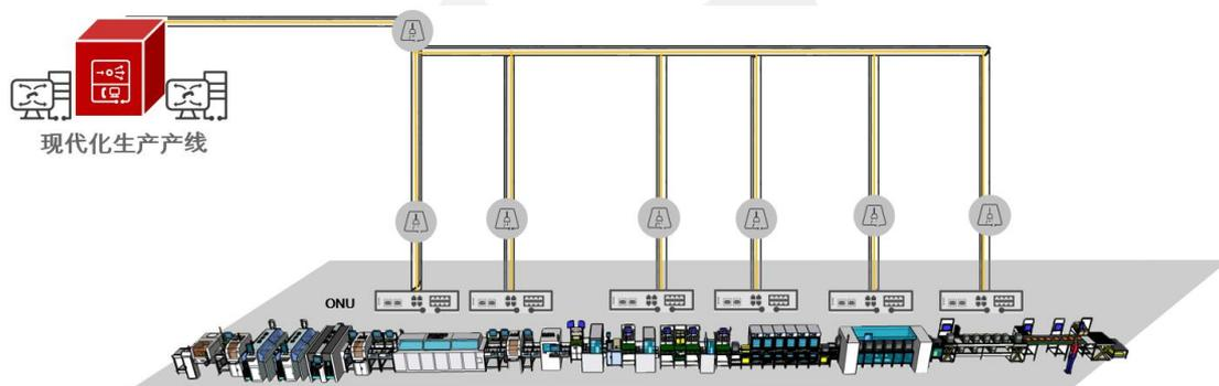
图4 采用工业PON技术组网架构图
