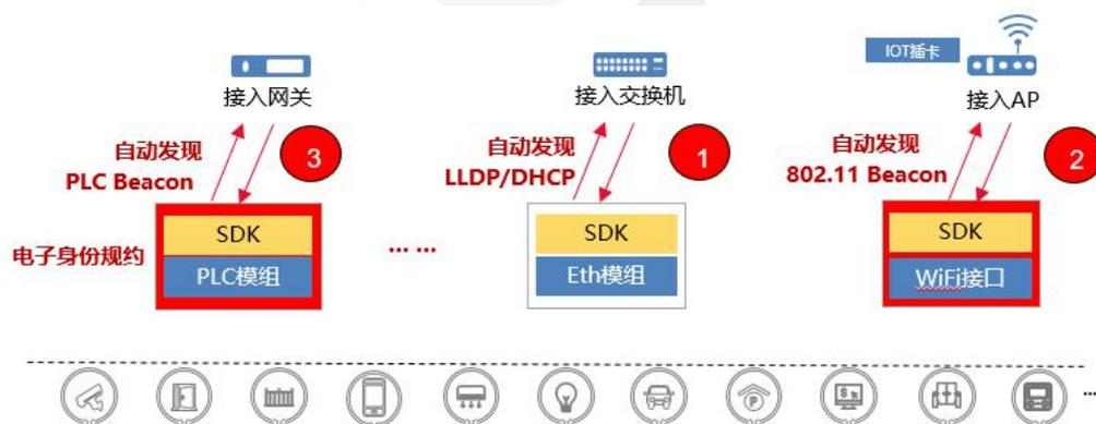
即插即用过程中，园区终端设备通过自动发现，基于电子身份规约，完成终端识别、自动引导入网。具体方式如下：
