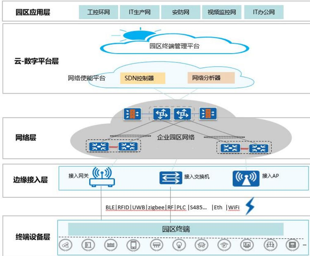
图 21 园区终端接入自动化解决方案总体架构图
