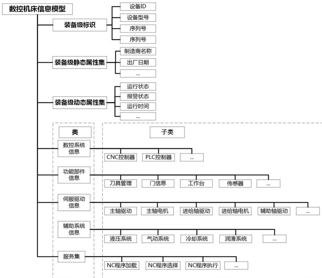
图 6-2 数控机床信息模型
