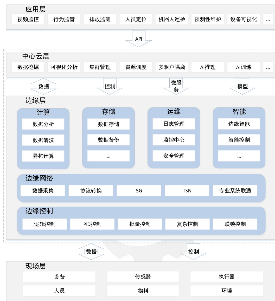
图 1 流程行业边缘计算功能架构图
