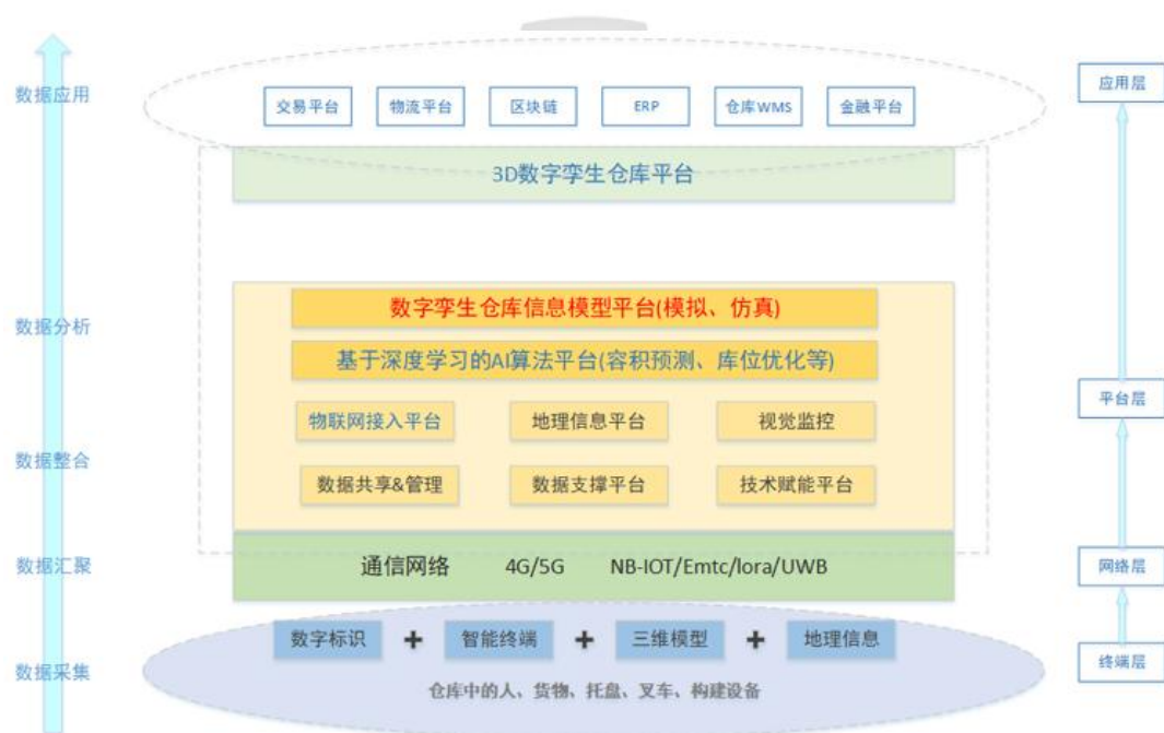
图 16 云仓数字孪生数据架构
