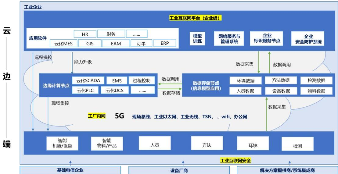
图2 5G全连接工厂基础设施建设参考架构
