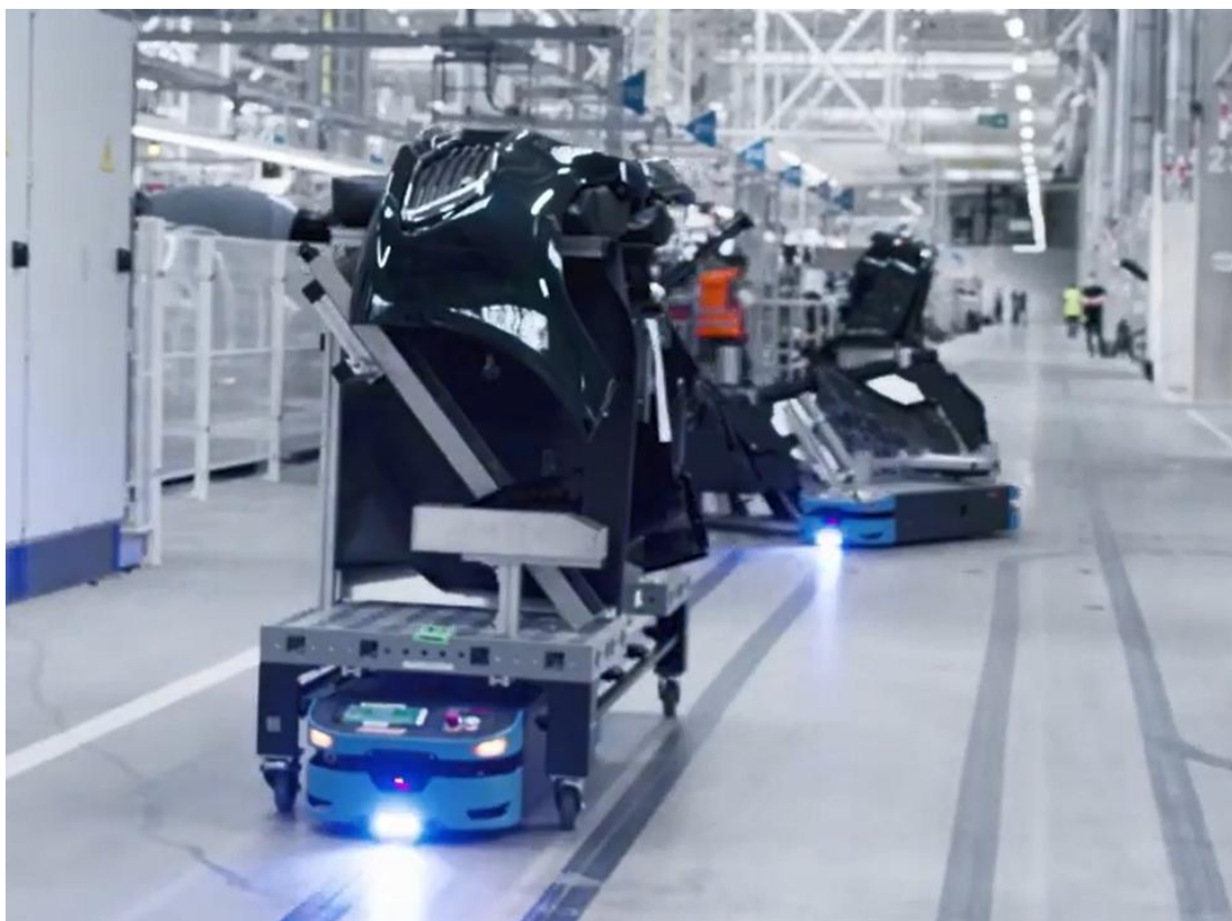
图 7 56 号工厂有 400 多台生产线 AGVs
