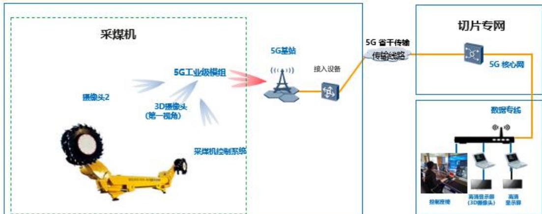
图 8 5G+无人化采掘系统示意图
