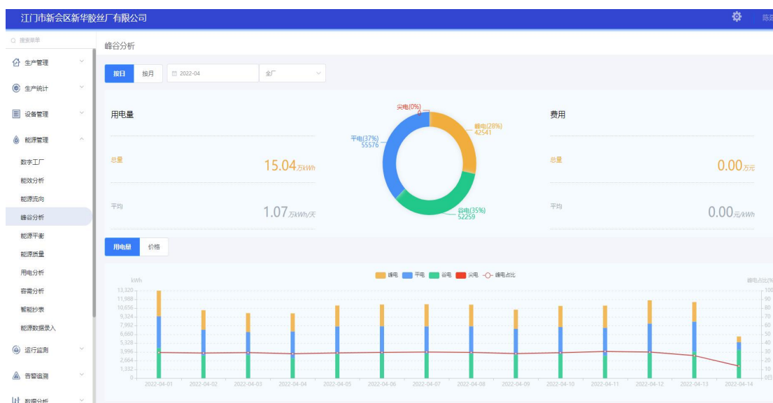
图 134 峰谷分析：峰谷平耗电分析，峰电占比曲线明确高峰点
