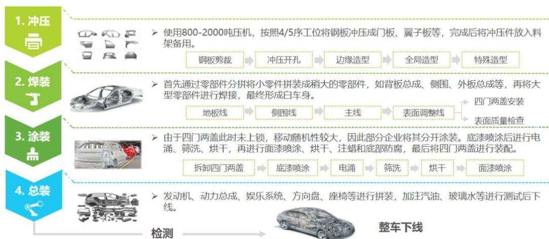
图 2-1 汽车四大工艺流程图
