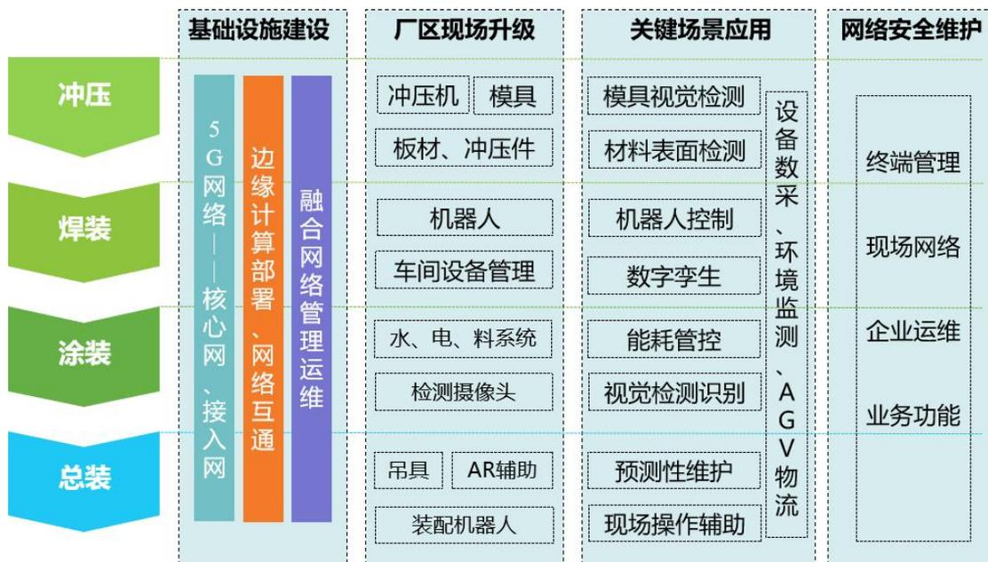
图 3-1 汽车制造业 5G 工厂建设实施架构
