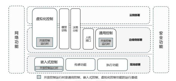
图1 开放自动化系统参考功能架构图
