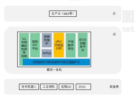
图A. 6.1 基于开放自动化系统的控制架构
