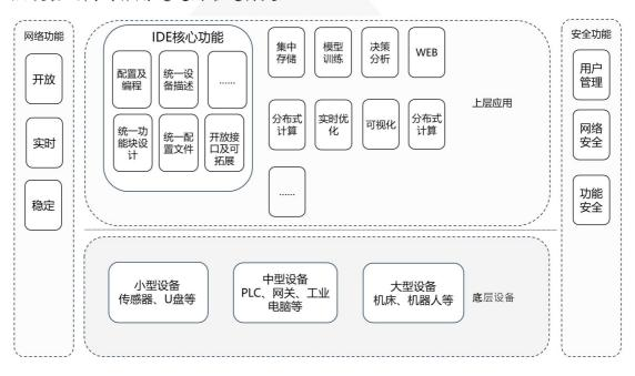
图A. 2.1 基于开放自动化的分布式控制系统架构
