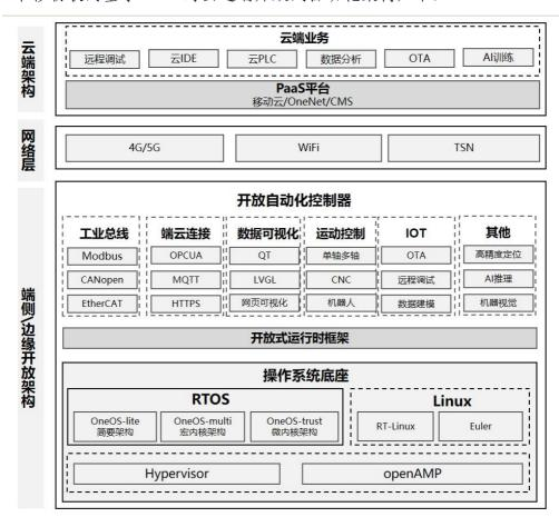
图A. 5. 1: 中移物联网基于0ne0S的工业开放架构
