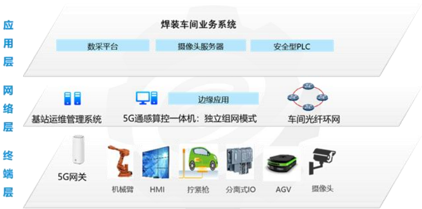
图 14 汽车制造焊装车间系统方案架构
