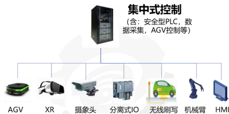
图 13 焊装车间产线集中式控制示意
