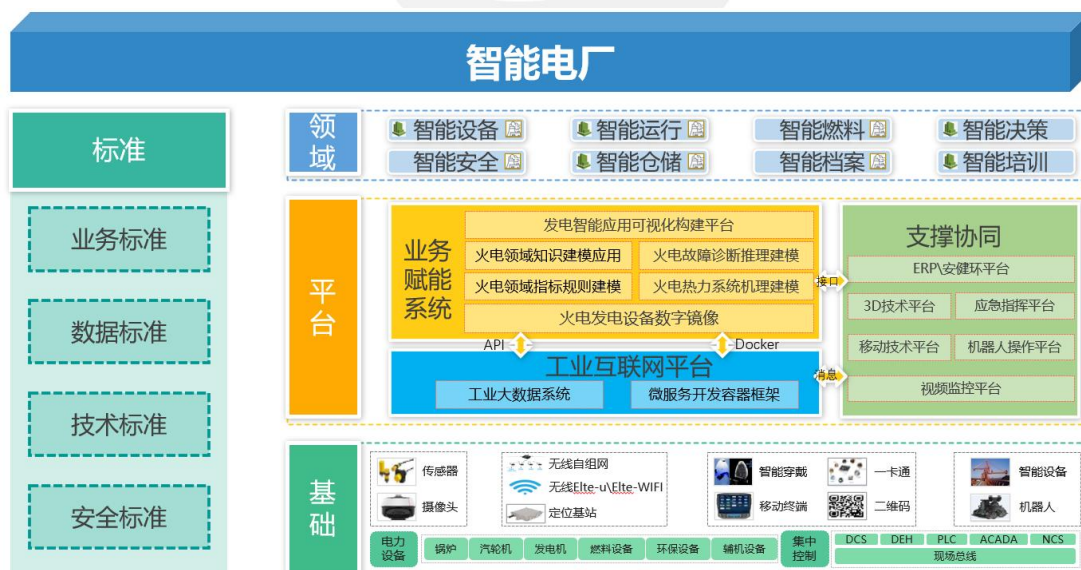
图 13. 智能电厂技术架构示意图
