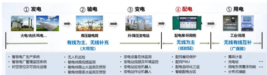
图 8. 电力行业各环节 5G 网络支撑示意图
