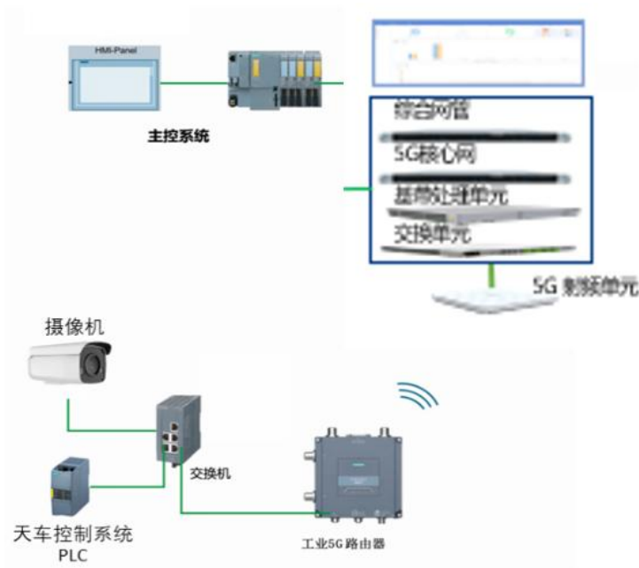
图 24. 5G 天车远程控制示意图
