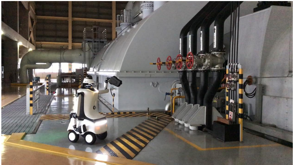
图 19. 智能巡检机器人应用示意图
