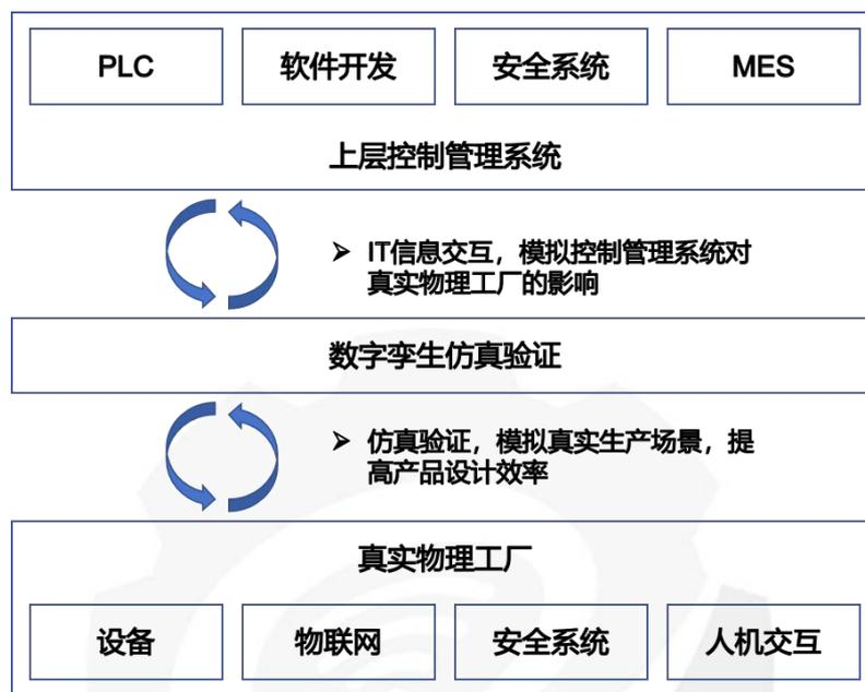
图 8 确定性数字孪生逻辑结构
