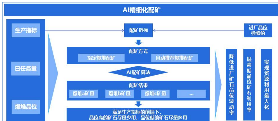
图 10 精细化配矿原理图
