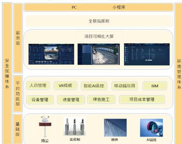
图 1：方案架构图
